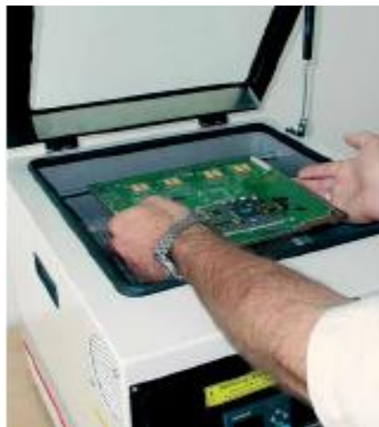
Obr.2 Umístění PCB na roštu před spuštěním
